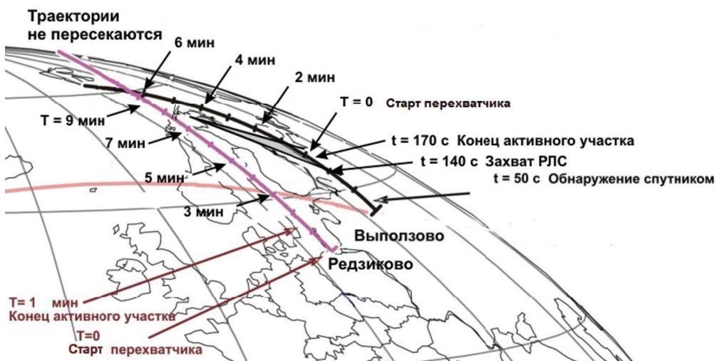
Рисунок 1. Взаимное расположение траекторий полета МБР РС-12М и перехватчика SM-3 Block 2A
